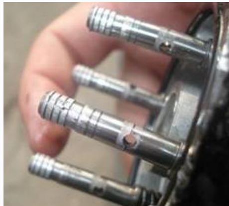
柱塞磨损严重
